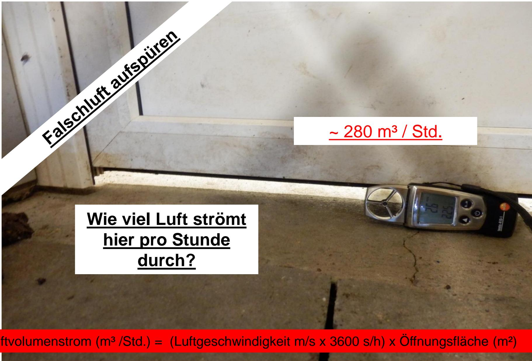
$$\text{Luftvolumenstrom (m}^3\text{ /Std.)} = (\text{Luftgeschwindigkeit m/s} \times 3600 \text{ s/h}) \times \text{Öffnungsfläche (m}^2\text{)}$$
